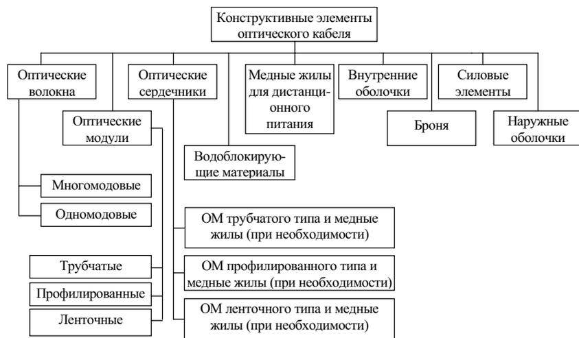
Рис. 7. Основные конструктивные элементы оптического кабеля
