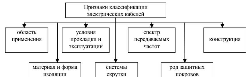
Рис.1. Классификация электрических кабелей
