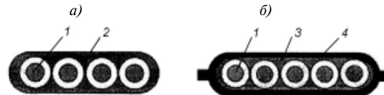
Рис. 9. Примеры конструкций ленточного ОМ:
