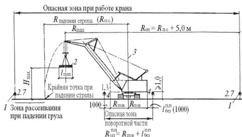
Рис. 9. Схема назначения и расчета зон стрелового крана, не оборудованного устройством, удерживающим стрелу от падения:
