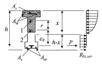
Рис. 6. Схемы усилий и эпюры напряжений в поперечном сечении элемента при расчете его по образованию трещин, нормальных к продольной оси элемента, при изгибе:
