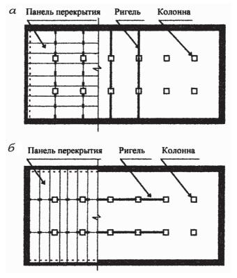
Рис.2. Схемы компоновки сборного перекрытия с поперечным (a) и про-дольным (б) расположением ригелей
