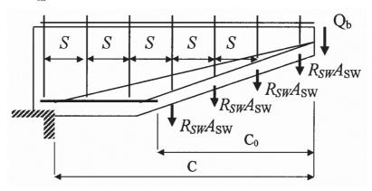
Рис. 5. Схема усилий в сечении, наклонном к продольной оси изгибаемого элемента
