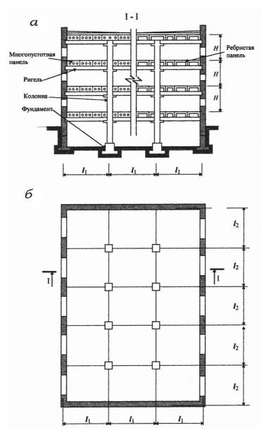
Рис. 1. Поперечный разрез (а) и план типового этажа (б) здания
