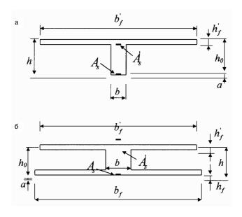
Рис. 4. Расчетные поперечные сечения ребристых (a) и пустотных (б) панелей
