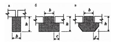
Рис. 3. Формы поперечного сечения ригеля
