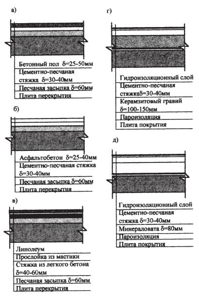
Рис.1.П. Примеры разрезки перекрытий (а,б,в) и покрытий (г,д)
