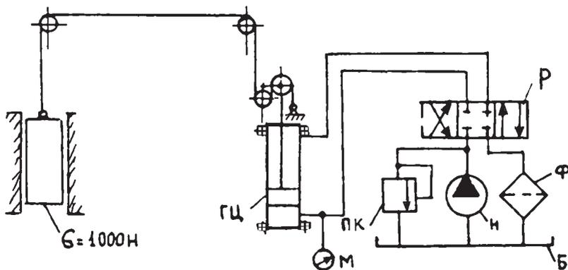
Рис. 4:  $G$  – груз; ГЦ – гидроцилиндр;  $P$  – распределитель;  $H$  – насос; ПК – предохранительный клапан;  $\Phi$  – фильтр;  $B$  – бак;  $M$  – манометр.
